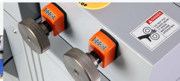
Las perillas permiten ajustar los rodillos de recubrimiento de manera fácil en incrementos de 0.1mm
