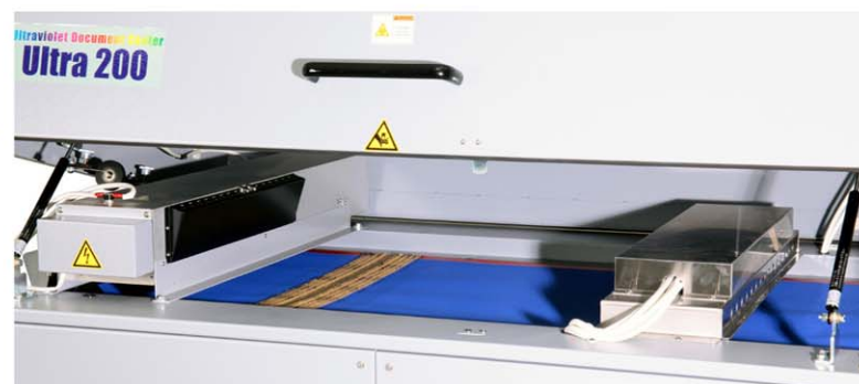
La Banda Transportadora es larga y con lámparas UV e Infra Roja
